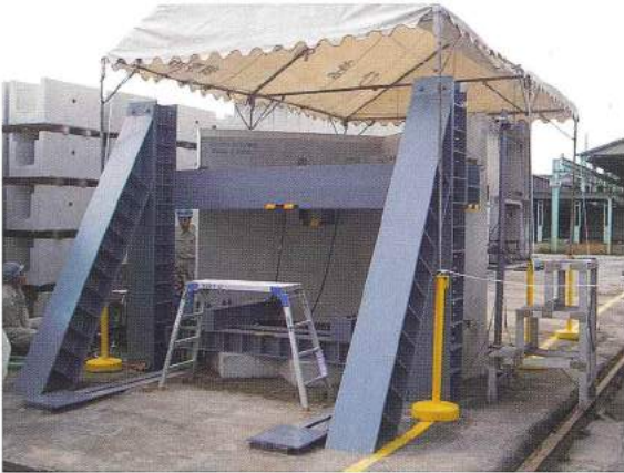
コーナー擁壁の実物载荷試験 (擁壁に荷重を載荷し、耐力をチェック)
