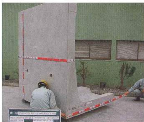
大地震対応擁壁の開発 宅地造成等規制法施行令第14条に基づく、 設計水平震度 K_h=0.25 に対応する 「大地震対応型」擁壁を開発しています。
